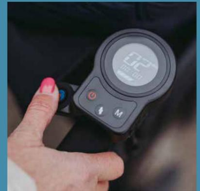
Die Begleitperson kann die elektrische Schiebehilfe und Bremsunterstützung aktivieren.
